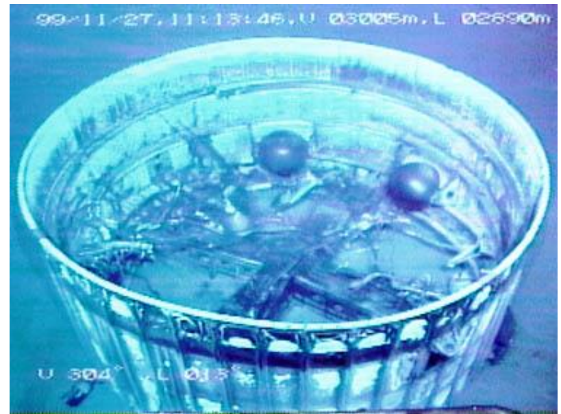
ロケットのエンジン内部の配管
